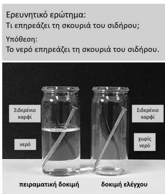
Εικ. 4.1α: Πειραματική δοκιμή και δοκιμή ελέγχου
